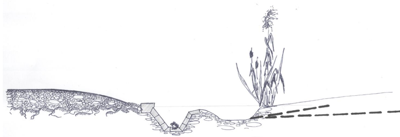
Ábra 12. A vízelvezető hálózat struktúrája az ideglenes technológiai utak mentén
